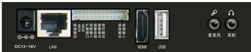
1、**电源**：将随机附送的开关电源插入电源接口上给主机供电。
