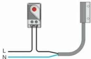
接线说明: 随机附送的电源线只需要接L、N两根线 (L: 电源棕色线; N: 电源蓝色线) AC220V供电, 注意安全!
